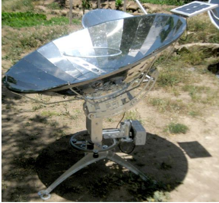
Şekil 5. Güneşi takip eden yeni nesil güneş ocağı
